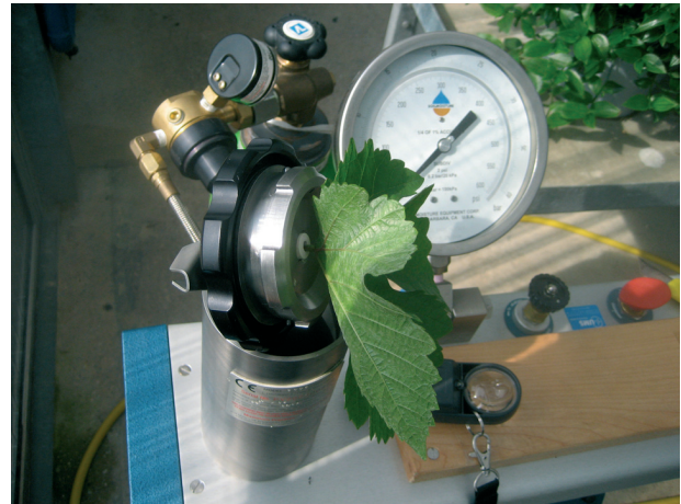
Abb. 1: „Scholander-Bombe“ zur Messung des Blattwasserpotenzials
