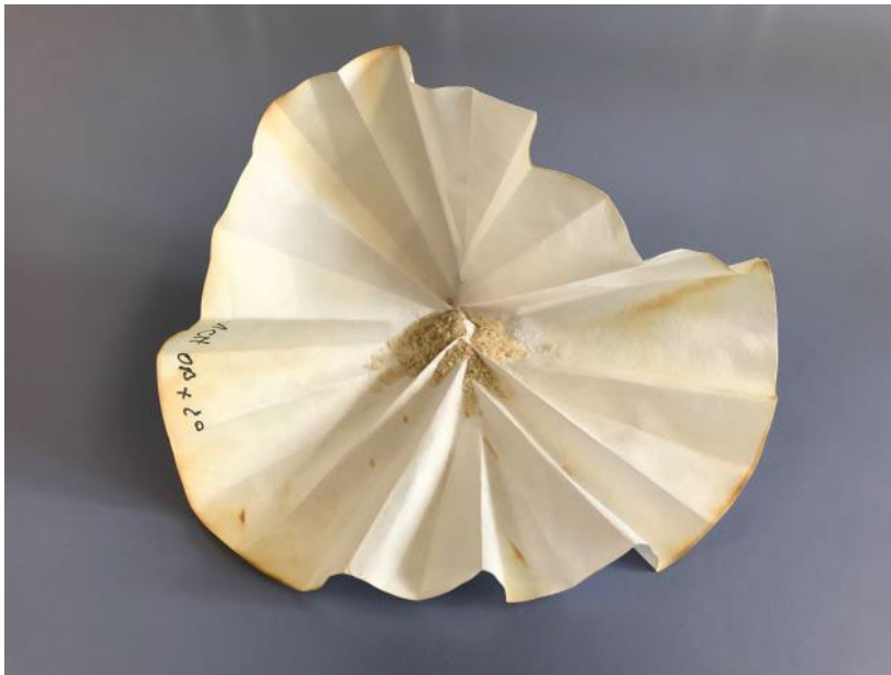
Abbildung 2: Getrockneter Filter mit Weinstein (KHT)
