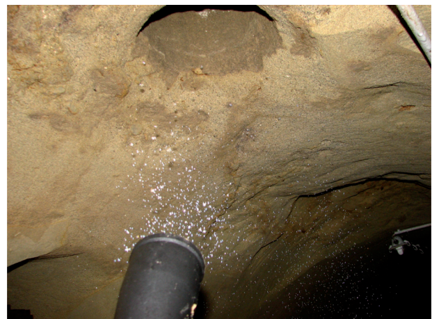
Abb. 1: Darstellung der Strömungsbedingungen in einem Keller mittels Heliumbläschen aus dem Bubblegenerator
