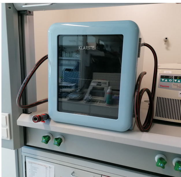
Abbildung 43: Umgebauter Kühlschrank für Gasversuche
