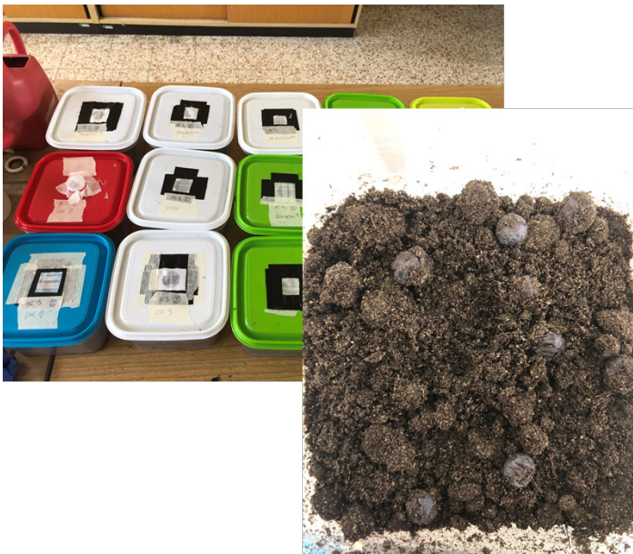
Abbildung 36: Versuchsanordnung zum Test der Nematodenwirkung im Labor: Bild links: Versuchsböden. Bild rechts: Mit Eiern belegte Heidelbeeren wurden in den Böden auf Erde platziert und mit den Nematoden begossen.
